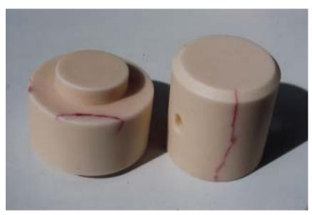
Fehlerhaftes Guß-Gehäuse / Faulty cast casing
